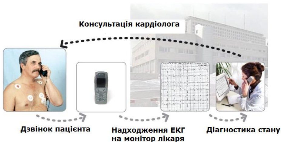
Рис. 2. Схема роботи транстелефонного ЕКГ комплексу «Телекард» [5]
