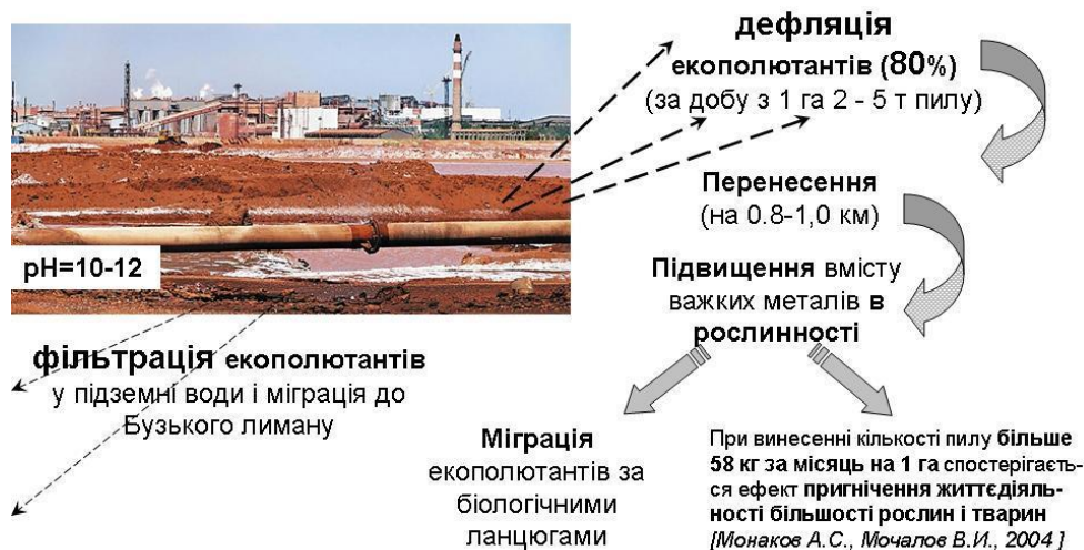
Рис. 1. Схема перенесення у довквіллі екополютантів шламосховища червоних шламів (на прикладі Миколаївського глиноземного заводу)
