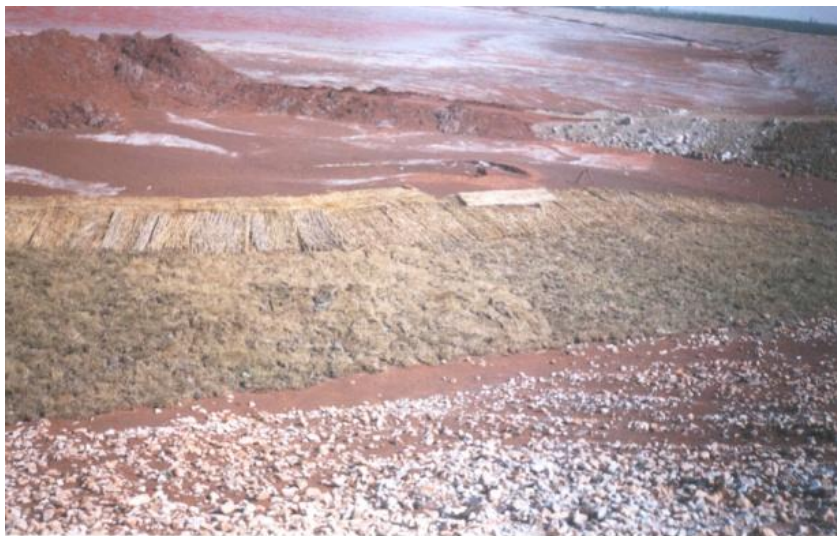
Рис. 3. Експериментальна ділянка на МГЗ, вкрита пілопригнічувальними біоматеріалами
