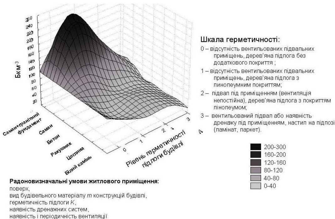
Рис. 5. Сплайн – моделювання залежності ЕРОА ^{222}\text{Rn} від «радонівизначальних» умов приміщення
