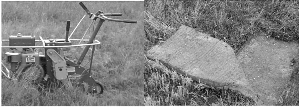
Рис. 2. Машина для снятия дернины TURF CUTTER
