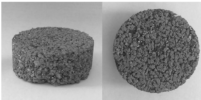
Рис. 3. Композит на основі губчастого титану з наповнювачем \text{SiO}_2
